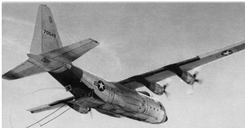
Αεροσκάφος JC-130B (57-0526), με ανεπτυγμένο το σύστημα ανάκτησης της δορυφορικής κάψουλας C-130 HERCULES IN ACTION (Squadron/Signal Publications Inc.)
