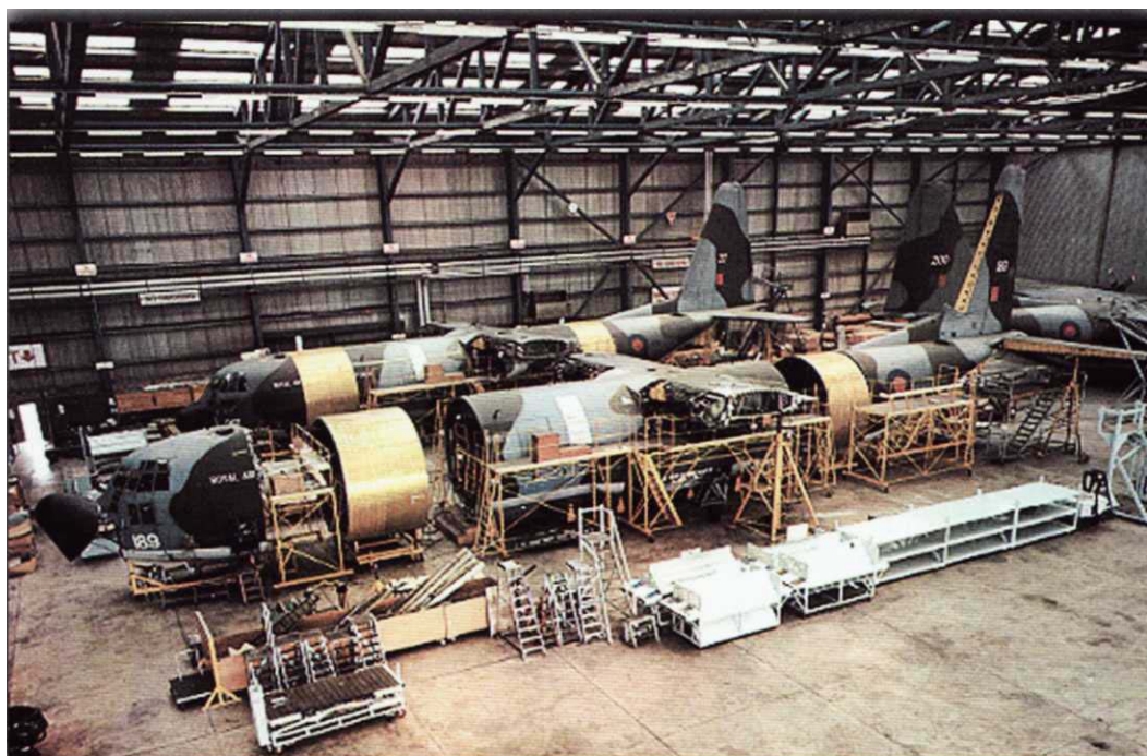
Επιμήκυνση αεροσκάφους C-130K της Βρετανικής αεροπορίας (RAF) Marshall of Cambridge Engineering Company
