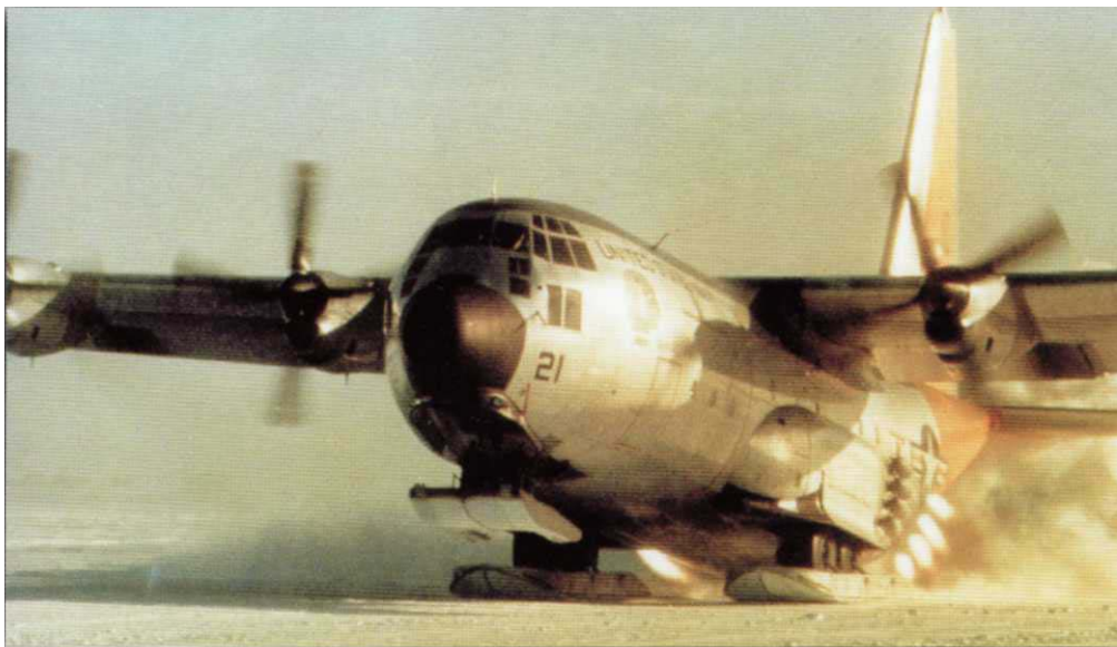
Αεροσκάφος LC-130F (148321) του Ναυτικού των ΗΠΑ, απογειώνεται στην Ανταρκτική, με τη βοήθεια ρουκετών MIGHTY HERCULES: THE FIRST FOUR DECADES (Royal Air Force)
