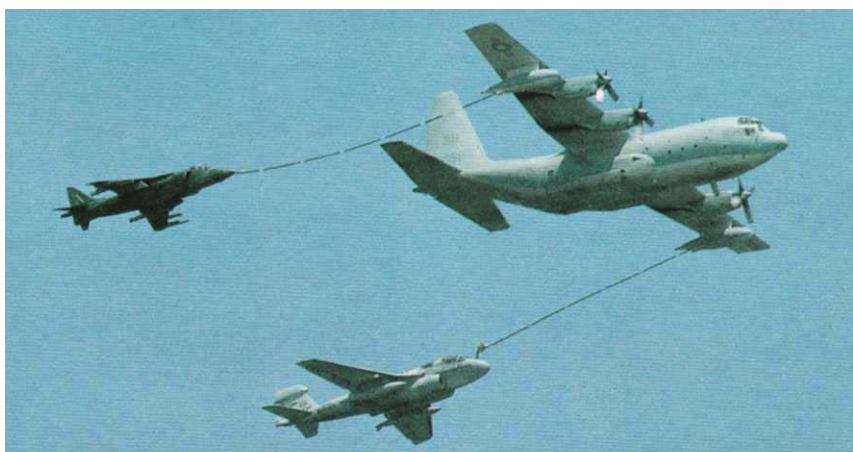
Αεροσκάφος KC-130F (148898) ανεφοδιάζει ένα EA-6B Prowler και ένα AV-8B Harrier WORLD AIR POWER JOURNAL: HERCULES (Aerospace Publishing Ltd)
