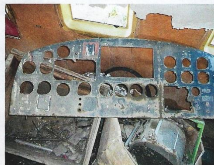
Ο κενός πίνακας οργάνων του «KN691» σε φωτογραφία του 2020. Έχει υπάρξει ένα απίστευτο μπέρδεμα ταυτοτήτων ανάμεσα στο C-47B «KN691» και το «KK169», το πρώην βορβορηστικό Dakota που σώζεται στο Μουσείο ΠΑ, στο Τατόι, με τα «data plate» των δύο αεροσκαφών να βρίσκονται αμφότερα στη λάθος άτρακτο! Θα μπορούσε κάποιος να δεχθεί ότι λάθη πάντα γίνονται. Όμως ο μηχανικός αεροσκαφών και ερευνητής της Αεροπορικής Ιστορίας Ιωάννης Μυλωνάς έχει βάσιμα στοιχεία ότι ίσως μιλάμε όχι για τυχαίο μπέρδεμα, αλλά για συνειδητή αλλαγή ταυτοτήτων! («The C-47 Dakota in the Hellenic Air Force-Part 3», σελίδα 107, Air-Britain Aeromilitaria, September 2016).
