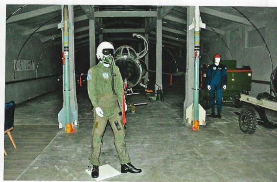
Χειριστής και υπόλογος της 336Μ ΟΛΥΜΠΟΣ μπροστά στο F-104G Starfighter s/n 6668. Στις δυο κολόνες διακρίνονται πύραυλοι αέρος-αέρος AIM-9P4. Πίσω από τον υπόλογο διακρίνεται γεννήτρια ρεύματος και αέρα τύπου M32. Με την παροχή πεπιεσμένου αέρα γίνονται η εκκίνηση των κινητήρων αεροσκαφών όπως των F/R-4E, ενώ η παροχή ρεύματος επέτρεπε στους τεχνικούς να εκτελούν εργασίες συντήρησης ή επισκευής στο αεροσκάφος.
