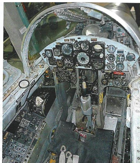
Το πιλοτήριο του F-104G s/n 6668. Φιλοξενεί το σπάνιο εκτινασόμενο κάθισμα C-2, με το οποίο παραδόθηκε στην ΠΑ από την ΚLu. Το ακόμη σπανιότερο survival pack του καθίσματος C-2 εκτίθεται στον χώρο των εκτινασόμενων καθισμάτων.
