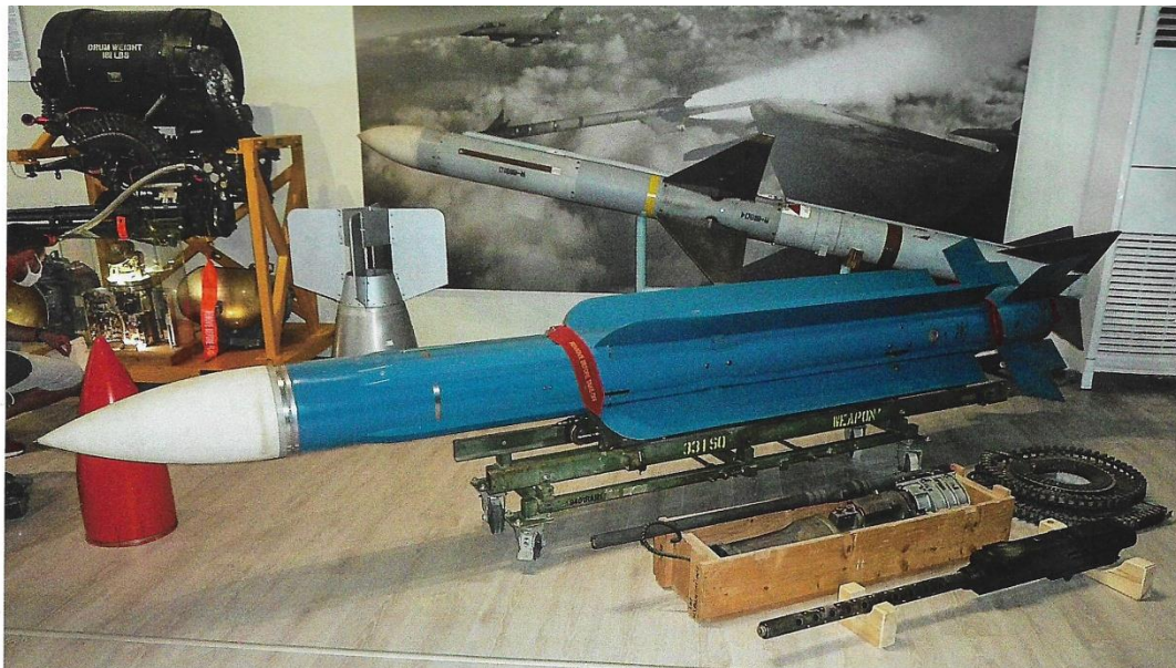
Πύραυλος αέρος-αέρος Matra Super530D με χρωματισμένα γαλάζιο σώμα και πτερύγια, ο οποίος από το 1996 εξόπλισε τα ελληνικά Mirage 2000 EGM/BGM. Πίσω του διακρίνεται AIM-7 Sparrow των F-4E και μπροστά του πυροβόλο Pontiac M39 των 20 mm αεροσκάφους F-5A μέσα στο ξύλινο κουτί του. Σε πρώτο πλάνο, πολυβόλο Colt-Browning M3 των 12,7 mm από τα παλαιότερα F/R-84F.
