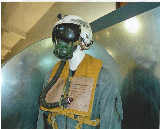
Πολύ σπάνια και ενδιαφέρουσα έκθεση εξοπλισμού ALSE (Aircrew Life Support Equipment) της δεκαετίας του 60: κάσκα χειριστή P-4B, μάσκα οξυγόνου χαμηλού ύψους (μέχρι 30.000 πόδια) mbu-4/p, σωσίβιο τύπου B-5 και φόρμα πτήσης K-2A.
