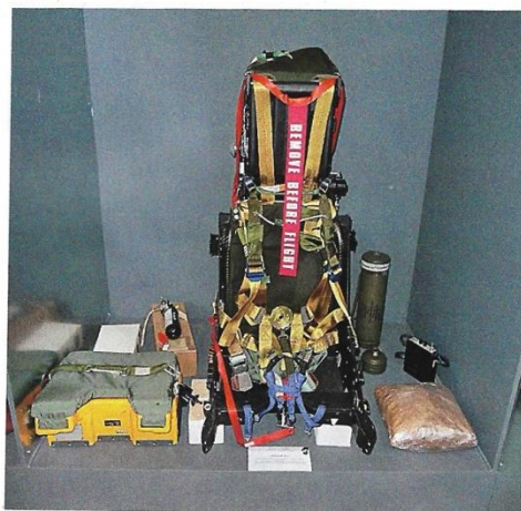
Ολοκαίνουργιο εκτινασόμενο κάθισμα Martin Baker Mk10 αεροσκάφους F-5A με το survival pack.
