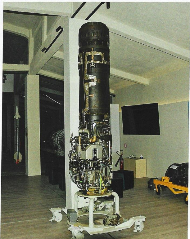
Turbojet J85 διкинητήριου αεροσκάφους F-5A. Παρήγαγε ώση 5.000 λιβρών.
