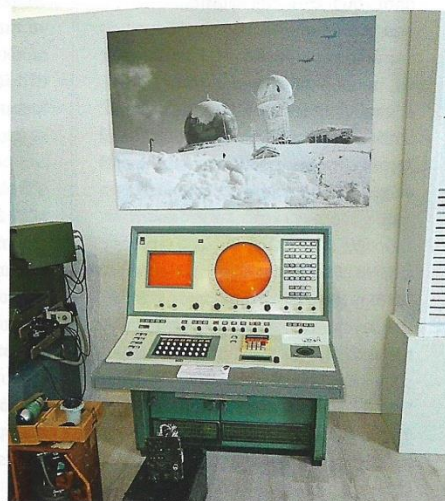
Κονσόλα διαχείρισης και τεχνικών ελέγχων του ραντάρ HR3000. Κατασκευάστηκε από τη Hughes και έχει μέγιστη εμβέλεια έρευνας τα 500 χιλιόμετρα και μέγιστο ύψος τα 30 χιλιόμετρα.
