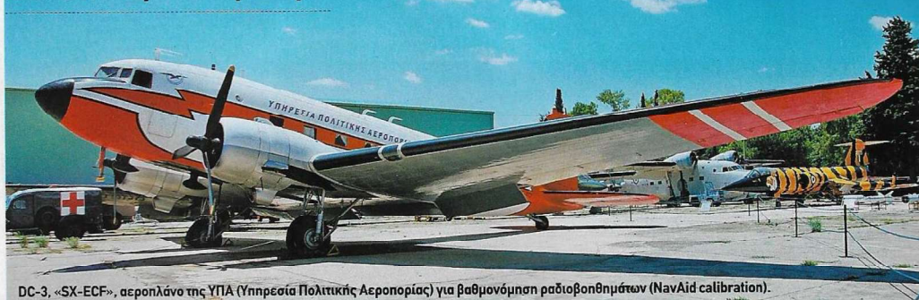
DC-3, «SX-ECF», αεροπλάνο της ΥΠΑ (Υπηρεσία Πολιτικής Αεροπορίας) για βαθμονόμηση ραδιοβοηθημάτων (NavAid calibration).
