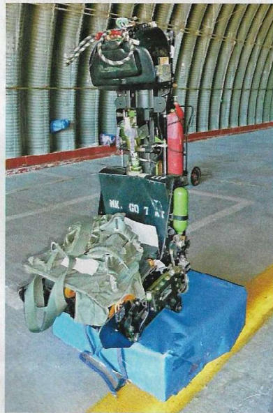
Εκτινασόμενο κάθισμα Martin Baker Mk.GQ-7 (A) από F/TF/RF-104G Starfighter.
