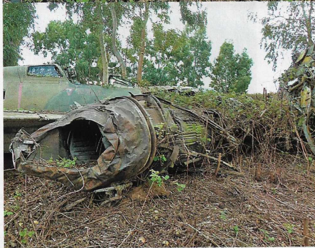
F-86D «51-6149» με καμένη την οπίσθια άτρακτο. Διακρίνεται καθαρά ο αεροκινητήρας General Electric J47-GE-17.
