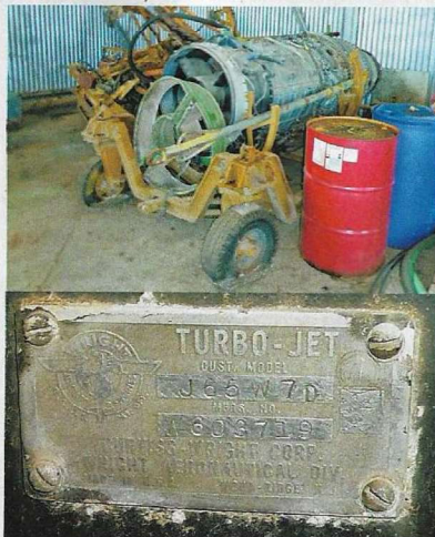
Αεροκινητήρας Wright J65-W-7-D από F-84F και data plate
