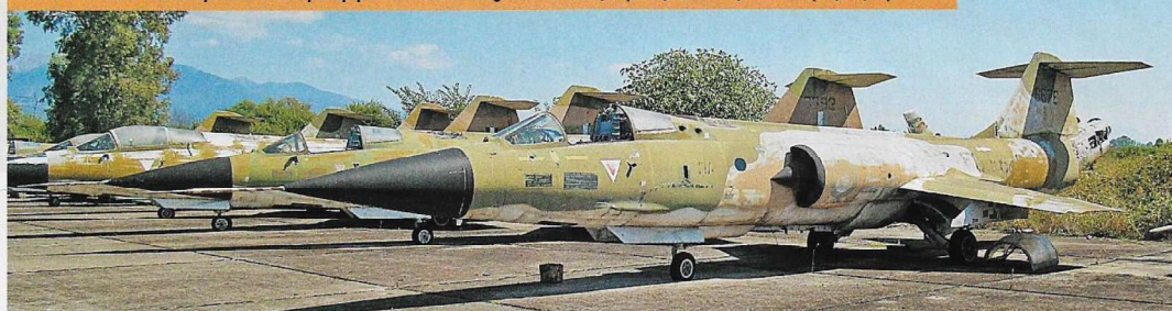
RF-104G «6676». Ιδιαιτερότητα του συγκεκριμένου recce Starfighter οι διπλές κεραίες RWR στις δύο πλευρές της στράκτου.
