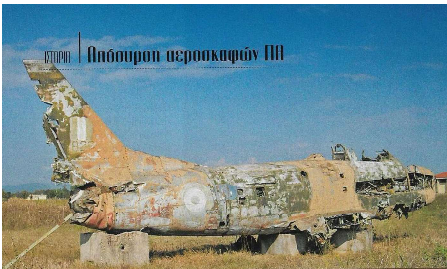
North American F-86D «51-8298» (9/2010). Για τη μεταφορά του από την 131 ΣΜ στην 132 ΣΜ στο Αγρίνιο τον Δεκέμβριο του 2004 αποκλειστικά για χρήση σε ασκήσεις πυρασφάλειας, απαιτήθηκε η αποκοπή των πτερύγων αυτού του Sabre Dog.
