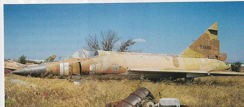
Convair F-102A «56-1056» (8/2010). Φαίνονται καθαρά στο ρύγχος τα μεταλλικά ελάσματα που τοποθετήθηκαν από εκπαιδευμένους στην ταχεία αποκατάσταση ζημιών μάχης (ΤΑΖΜΑ). Είναι πραγματικά κρίμα το ότι το συγκεκριμένο F-102Α, καθώς και το διπλανό του σπανιότατο T-33A Mk III «21269», δεν έχουν ενταχθεί ακόμα στο Μουσείο ΠΑ, το οποίο δεν διαθέτει αεροσκάφη των παραπάνω τύπων.
