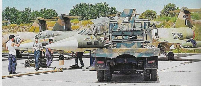
Δύο RF-104G («6672», «6674») και ένα TF-104G («5906») κατά τη διάρκεια αποψίλωσης των εξαρτημάτων τους λόγω μετάπτωσης σε κατηγορία E1 (132 ΣΜ, Ιούλιος 1996).
