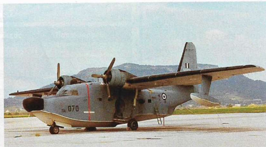
Τα αεροδυναμικά διηλεκτρικά καλύμματα στα πλευρά της στράκτου και πάνω από το πιλοτήριο του 51-0070 μαρτυρούν το ρόλο ELINT (Electronic Intelligence), που είχε αναλάβει τουλάχιστον από το Δεκέμβριο του 1974 και μέχρι την απόσυρσή του το 1996. (Θ. Β.)
