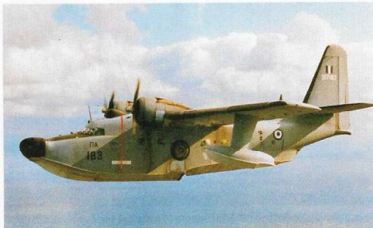
HU-16B 51-7183 (c/n G 235), πρώην WH-H, 330 Μοίρα. Η ΠΑ τροποποίησε συνολικά τρία HU-16B για αποστολές ηλεκτρονικής αναγνώρισης. Παρατήρηστε το διπλό αεροδυναμικό κάλυμμα πάνω από το πιλοτήριο. (353 ΜΝΑΣ)
