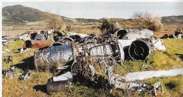
Χαρακτηριστική γωνία από όπου διακρίνονται πτέρυγες, εμπρόσθια και οπίσθια μέρη ατράκτου, κινητήρες κι ένα εκπινασσόμενο καθίσμα. Πεζιά, διακρίνεται το ρύγχος του F-84F s/n 52-8827.
