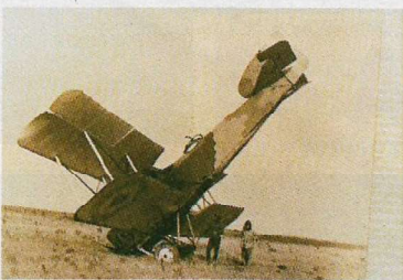
ΣΕΔΕΣ 1923 Breguet 14 «εις στάσιν αστεροσκοπίου». Προσέξετε την έλλειψη του δεξιού τροχού, ίσως αιτίας του ατυχήματός.
