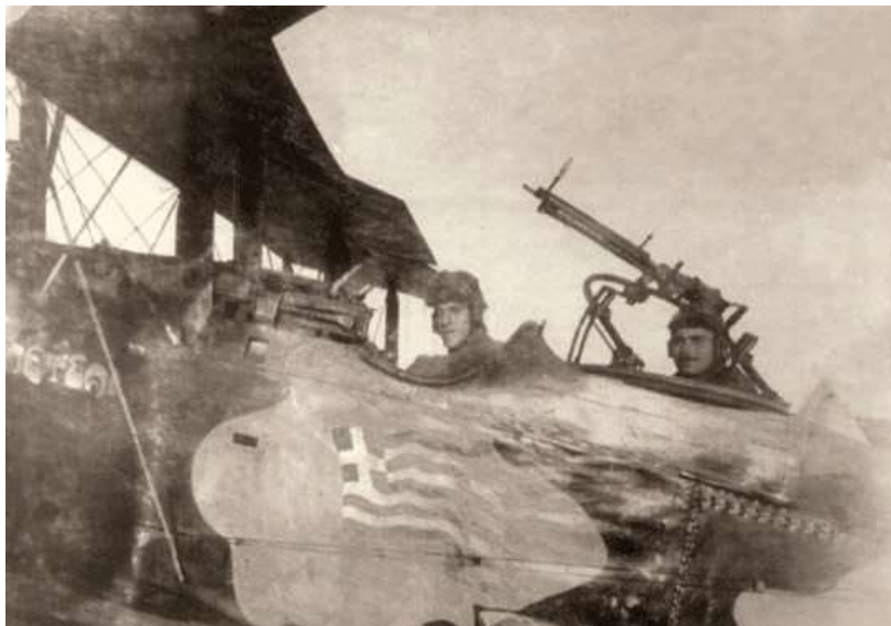
Εικόνα 20 Το αεροσκάφος «Σπέτσαι» τύπου Airco De Havilland D.H.9 στη Σμύρνη το 1919. Ήταν οπλισμένα με δύο πολυβόλα: ένα Vickers εμπρόσθιας βολής για το χειριστή και ένα περιστρεφόμενο Lewis για τον παρατηρητή (αρχείο Υπηρεσίας Ιστορίας Πολεμικής Αεροπορίας).
