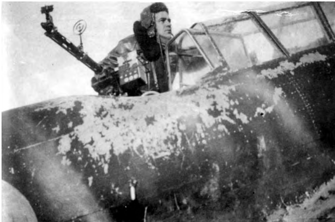
Φωτ. 52 - Po 63 τροποποιημένο με ελληνικής τοποθέτησης πολυβόλο FN
